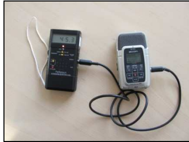
PETTERSSON D240X couplé à un enregistreur numérique
